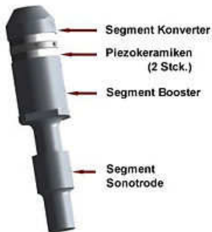
Abb. 7 Sonderentwicklung Konverter - Booster - Sonotrode
