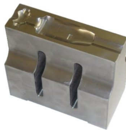
Abb. 20 Sonotrode mit 3D – Geometrie in der Arbeitsfläche
