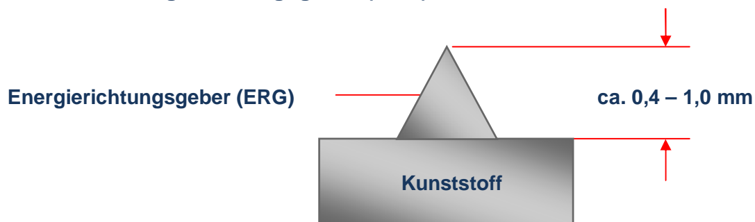
Abb. 10 Aufbauchema Energierichtungsgeber
